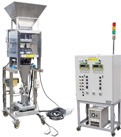
8924 人參縦型皮むき機 (人參用縦型皮剥き機)
